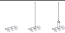
Монтажна планка Проволка за висящ монтаж Начин на инсталиране при открит монтаж
